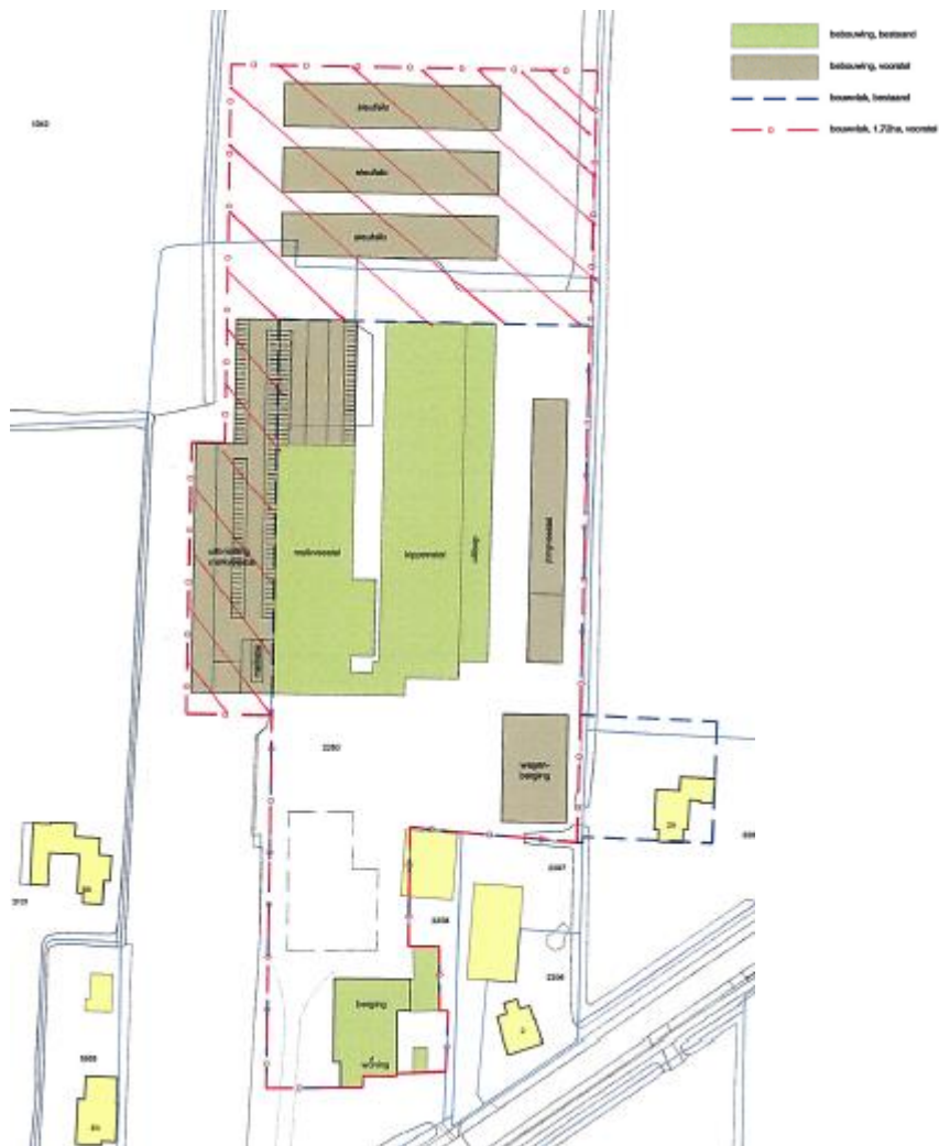
Figuur 2 Het plan voor de bouw van sleufsilo's en uitbreiding van de stallen van It West 4. Bron: Pietersma & Spoelstra.
