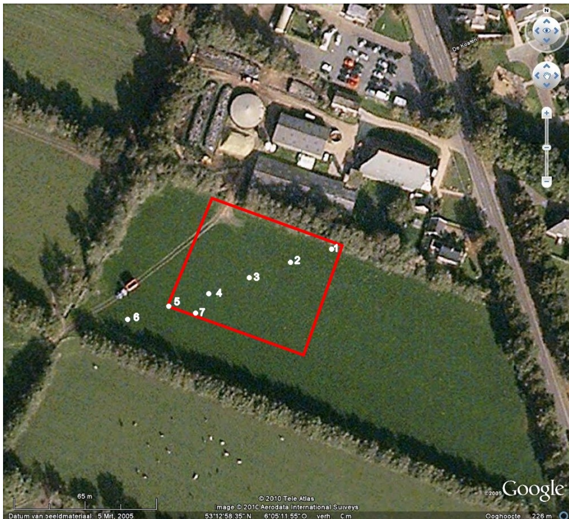
Figuur 7: Kootstertille, De Koaten 9: situatietekening met de boorlocaties [Naar: Google Earth]. De genummerde punten geven de uitgevoerde boringen weer. Het plangebied (de toekomstige ligboxenstal) is met een rode lijn aangegeven (RD-coördinaten plangebied: NW - 201,688 / 581,333; NO - 201,750 / 581,310; ZW - 201,669 / 581,291; ZO - 201,733 / 581,266).
