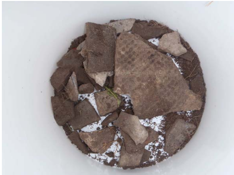
Proefgat B07: asbestverdachte materialen
