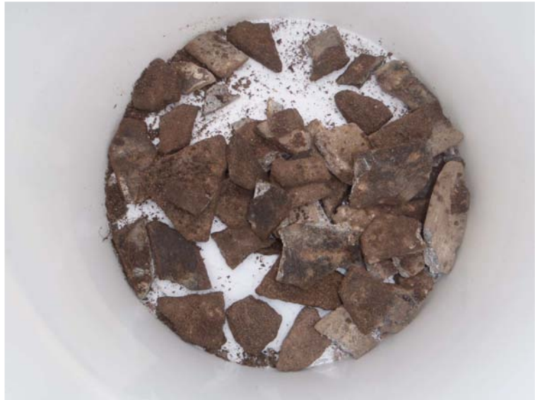
Proefgat B06: asbestverdachte materialen
