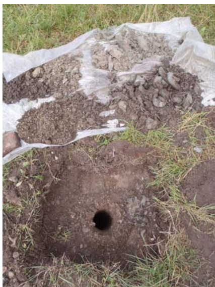
Proefgat B07: incl. boring 2,0 m-mv
