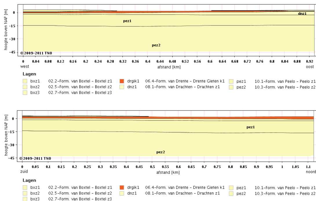
Figuur 3.2 Doorsneden A (boven) en B (onder) geven de regionale bodemopbouw weer
