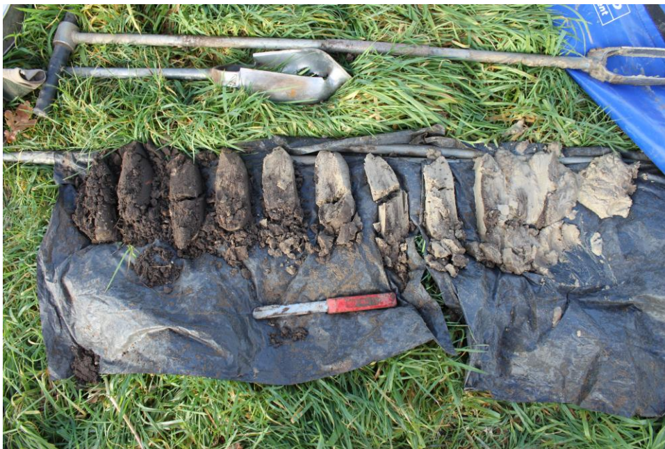
Figuur 1: Boring 4, afgetopt (dek-)zand niveau met een diffuse overgangslaag.
